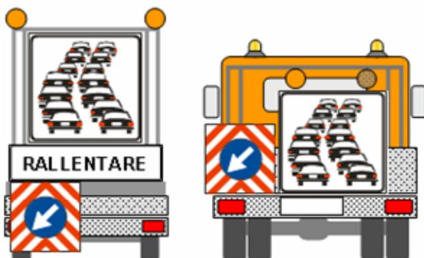
Figura 7: esempio di carrello e autocarro utilizzabili per la presegnalazione di code o rallentamenti (in alternativa al mezzo dotato di PMV full color). Il pannello "code" deve avere dimensioni non inferiori a 90x90 cm. Il cartello Fig. II 398 Art.38 Reg. (90x90) sul carrello, va obbligatoriamente applicato contestualmente al suo posizionamento.
