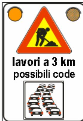
Figura 5: cartello di preavviso con lampeggiatori a led diam. 200 mm alta efficienza. Dimensioni 135x200 cm. Posizionamento sul margine destro su cavalletto a circa 3.000 m dal triangolo “lavori in corso”.
