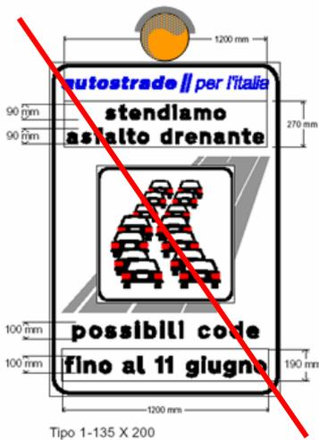
Figura 8: tabella “tipo 1” della segnaletica integrativa di comunicazione (Manuale Operativo per il Segnalamento temporaneo ed esecuzione dei lavori in autostrada – allegato 3)
