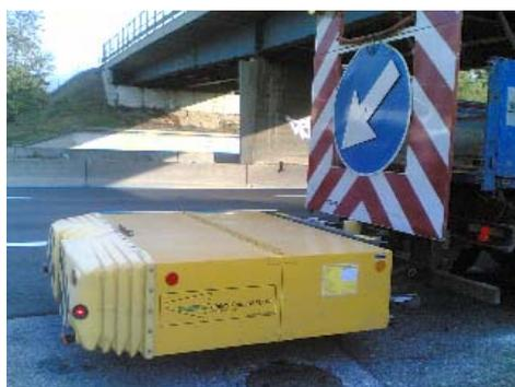
Figura 12: esempio di assorbitore d'urto abbinato a segnale mobile di protezione fig. II 401 art. 39 Reg.
