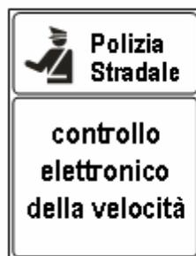
Figura 19: cartello di preavviso 90x135 da posizionare su cavalletto in anticipo rispetto alla posizione del box autovelox mobile
