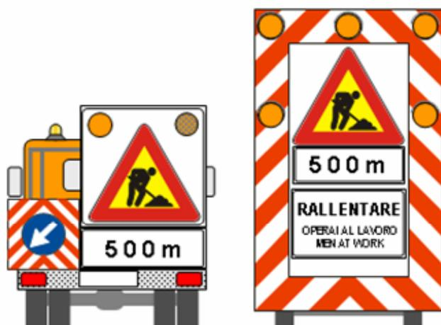
Figura 14: esempi di presegnalazione di cantiere mobile in corsia di emergenza; il pannello segnaletico con appendice distanziometrica deve in ogni caso contenere un triangolo "lavori in corso" con lato 120 cm e, nel caso dell'autocarro, essere integrato con lampeggiatori a led diam. 200 mm ad elevata efficienza
